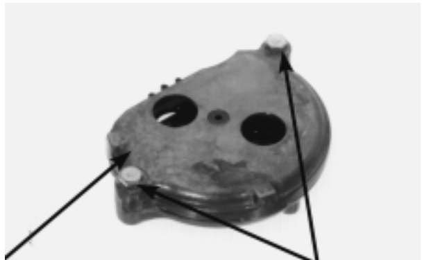
TAMPA ENGRENAGEM DA BOMBA EIXO DO ROTOR PARAFUSOS
